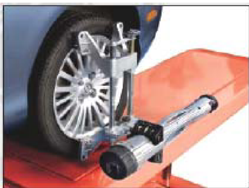
Obr. 3.4 kamera uchytaná na zadnom kolese - prevzaté z [12]
