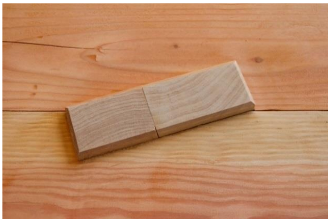
Obr. 9 Naklopený hmoždík ve tvaru klínů z javorového dřeva; Fire tower engineered timber 2019
