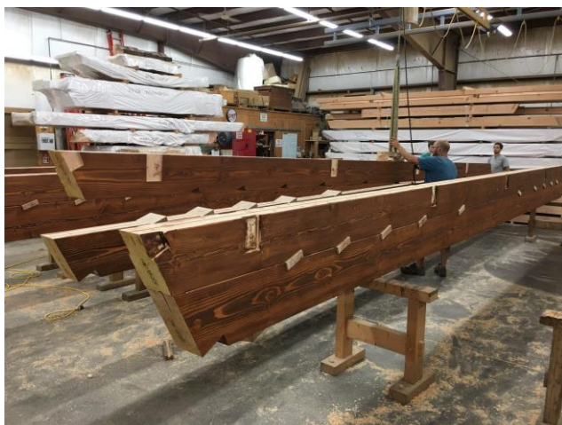
Obr. 25 Ukázka roštu z hranolů velkého průřezu a relativně nízkým počtem hmoždíků; New energy works 2019 )
