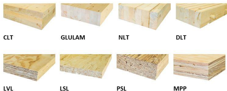
Obr. 2 Přehled konstrukčních materiálů z masivního dřeva; Perkinswill 2019
