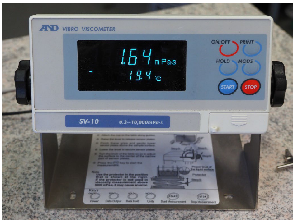
Obr. 13 Zobrazovací jednotka vibračního viskozimetru SV-10 s hodnotou dynamické viskozity a teploty měřeného roztoku parenterální výživy (zdroj: autor)
