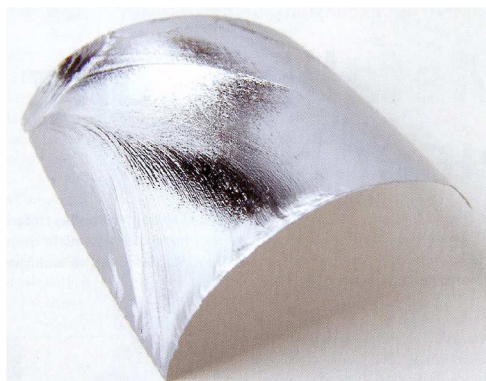
Obr. 2: Ultratenká fólie z krystalického křemku [7]
