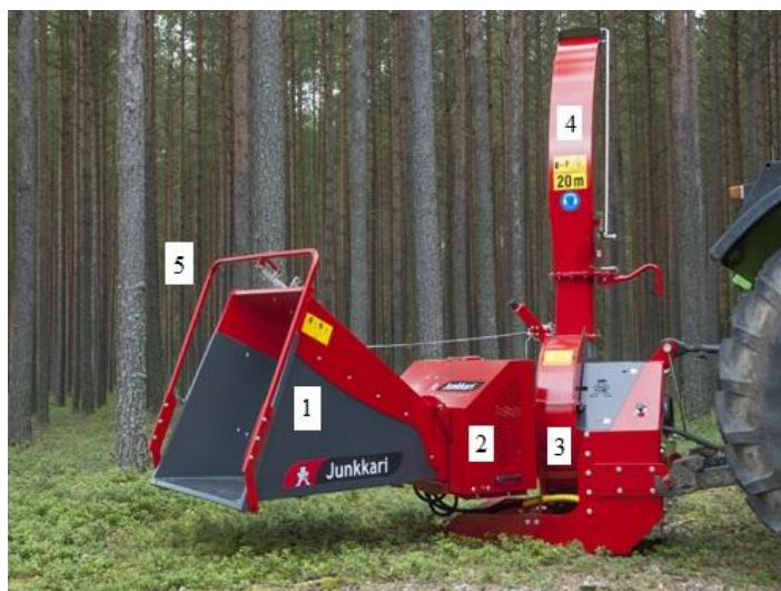
Obr.17- Diskový štěpkovač Junkkari nesený traktorem.
