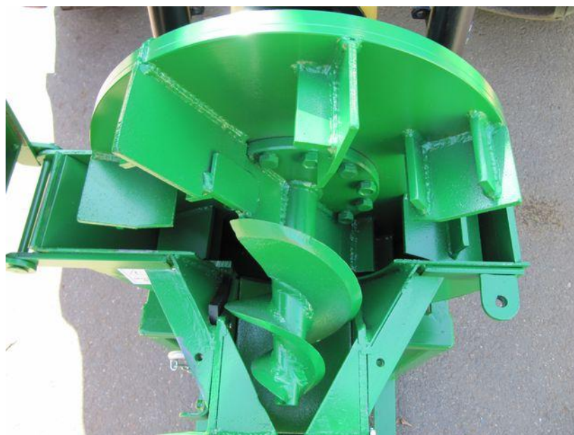
Obr.19- Mechanismus šnekového štěpkovače (Bystroň, 2007)
