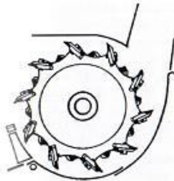
Obr.14 – Schéma bubnového štěpkovače (Pastorek, Kára, Jevič 2004)
