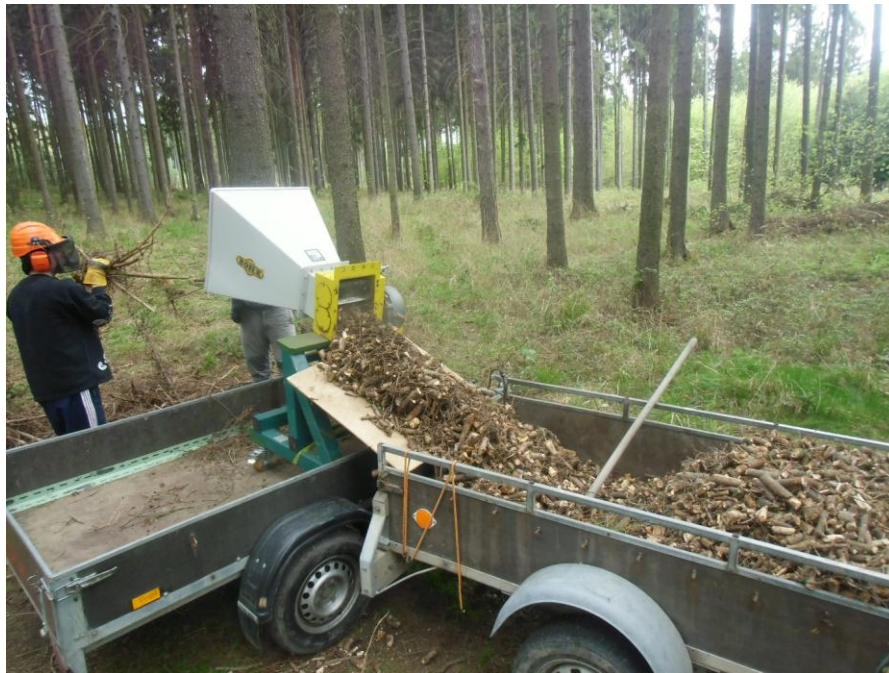
Obr.29- Drcení suchého smrkového klestu do přívěsného vozíku používaného jako odměrnou nádobu
