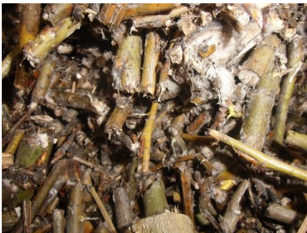
Obr. 34- Napadení špalíků plísní v boxu bez větracího komínku
