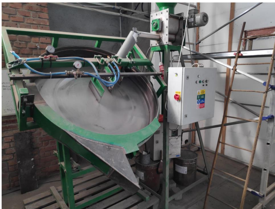
Obrázek 22: Peletizační talíř spol. Svoboda a syn, s.r.o.
