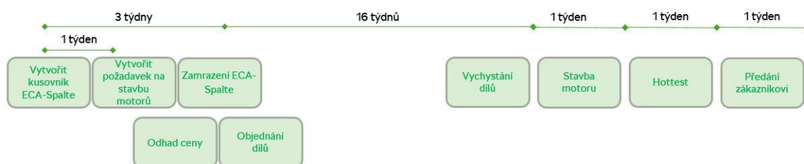
Obr. 9 Časový průběh procesu stavby prototypových motorů
