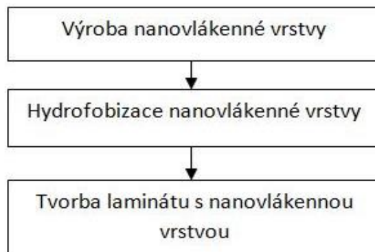
Obr. 11: Schéma postupu výroby laminátu s nanovláknennou vrstvou
