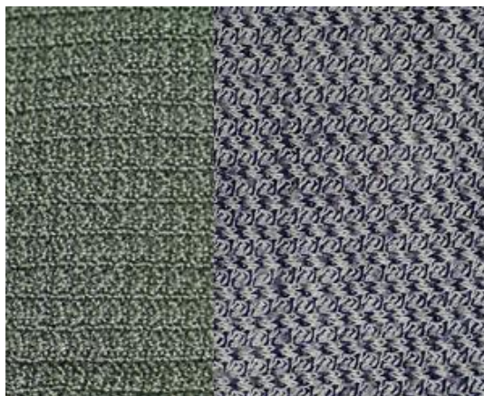
Obr. 9: Ukázka struktury termoprádla - vlevo letní, vpravo zimní [4]
