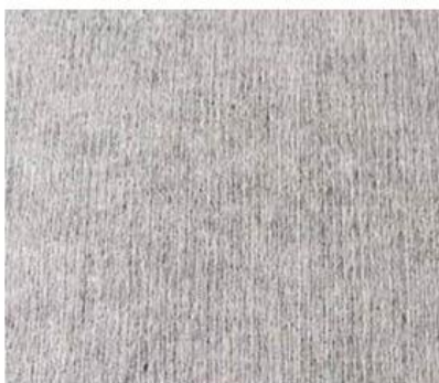
Obr. 39: Struktura netkané textilie Spunlace od firmy Dupond
