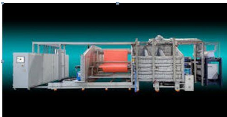
Obr. 18: Nízkovakuová plazma typu roll-to-roll [55]
