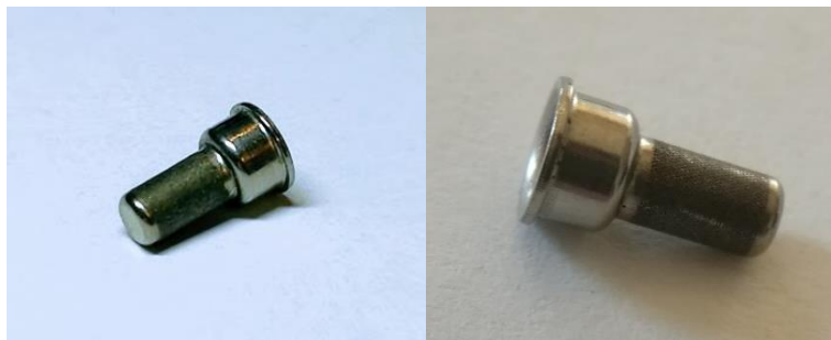
Obr. 7) Filtr ventilu PCV
