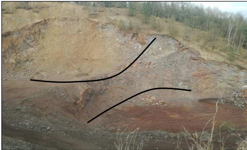
Obr. 9 Dvě etáže těžby v Doubravickém lomu
