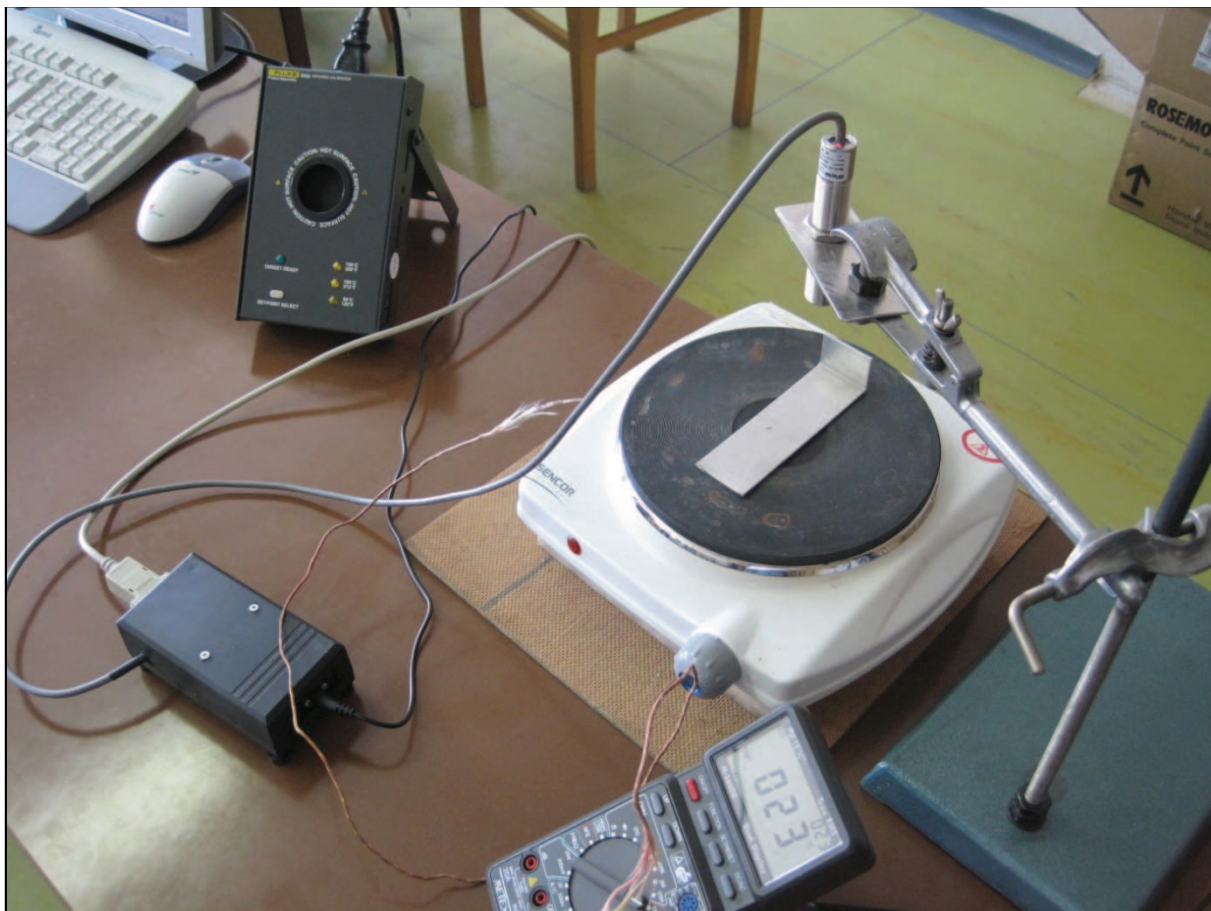
Obr. 4.8 - Měřící pracoviště – Ověření závislosti nastavení emisivity pomocí Compact CM a dotykového teploměru – pozn. výsledek měření uvádí další kapitola
