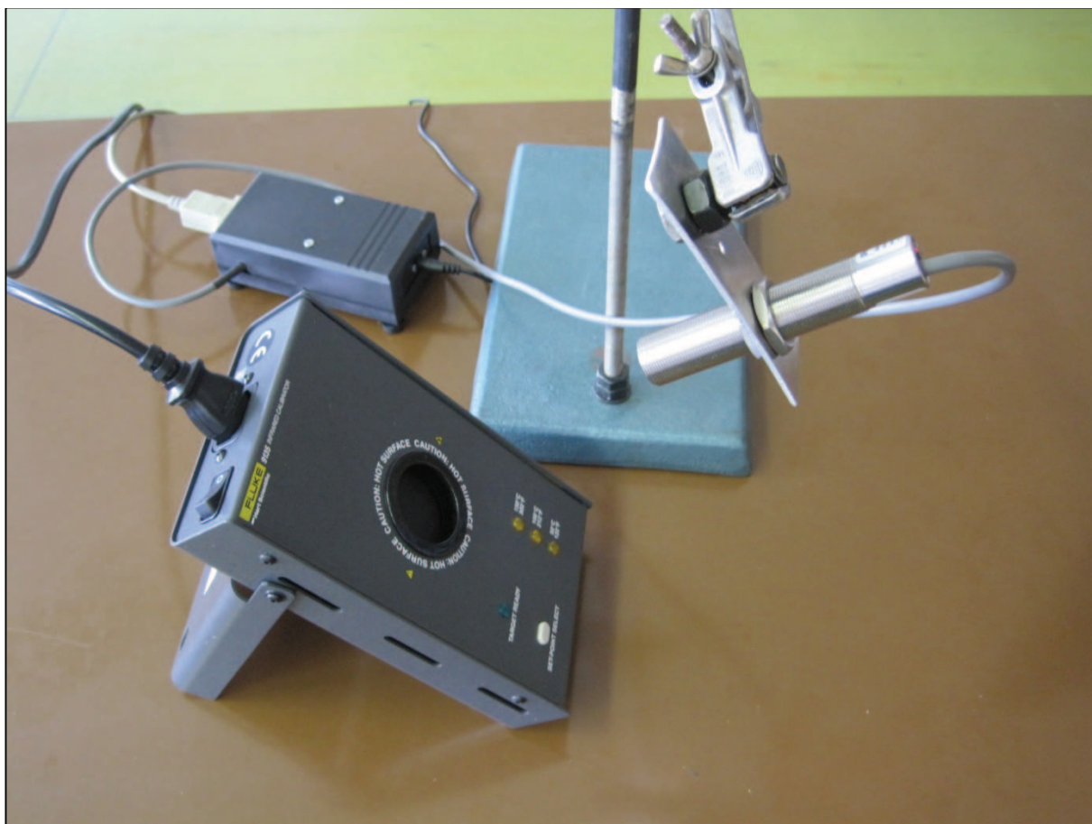
Obr. 4.7 - Experimentální měřící pracoviště (Compact CM, 3-bodový IR kalibrátor, krabička pro zapojení) – pozn. výsledek měření uvádí další kapitola
