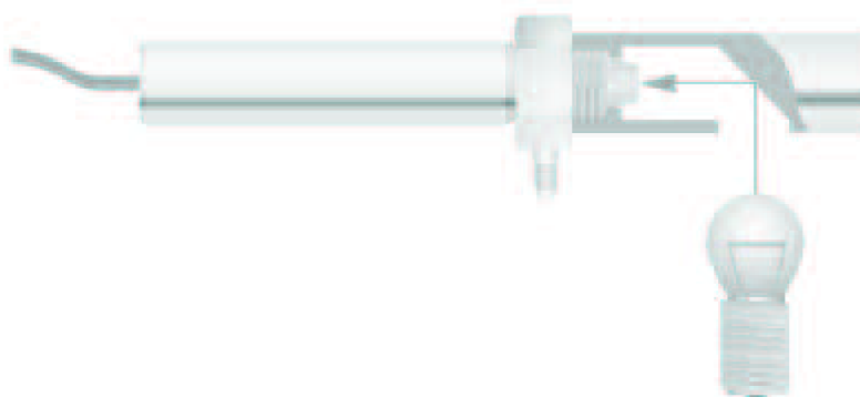
Obr. 2.15 – Zrcadlo na použití ve stísněném prostoru při měření infračerveným termočlánkem
