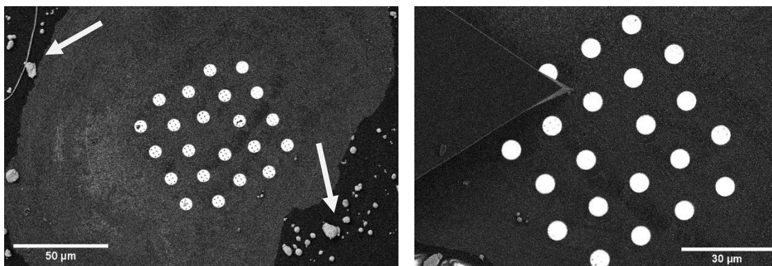
Obrázek 15: Střed topné spirály použitého \mu Heateru před (vlevo) a po (vpravo) nájezdu hrotu. Světle šedá část na snímcích je oblast pokrytá zlatem. Na levém snímku se nacházejí neroztavené částice zlata označené šipkami.
