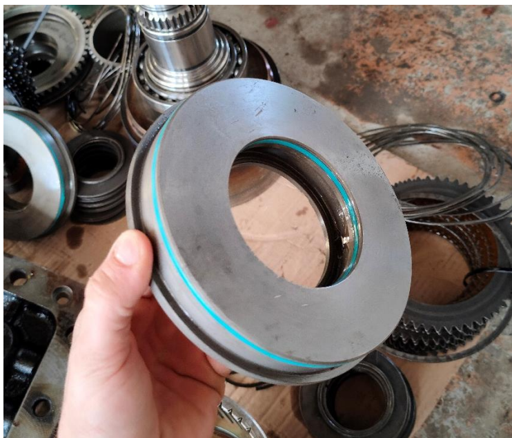
Obrázek 3.7: Píst pro spínání lamelových spojek
