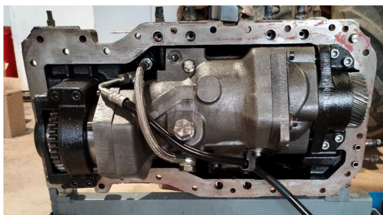
Obrázek 1.16: Hydrostatická část převodovky
