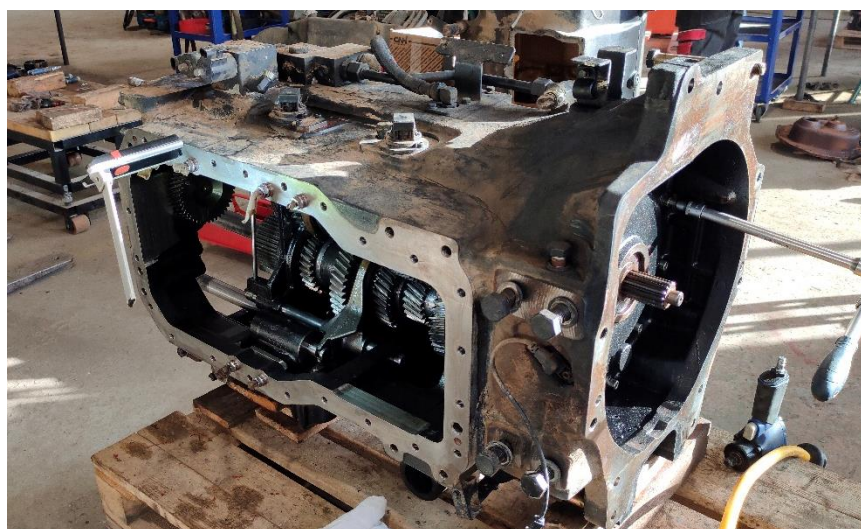
Obrázek 4.3: Skříně mechanické části převodovky
