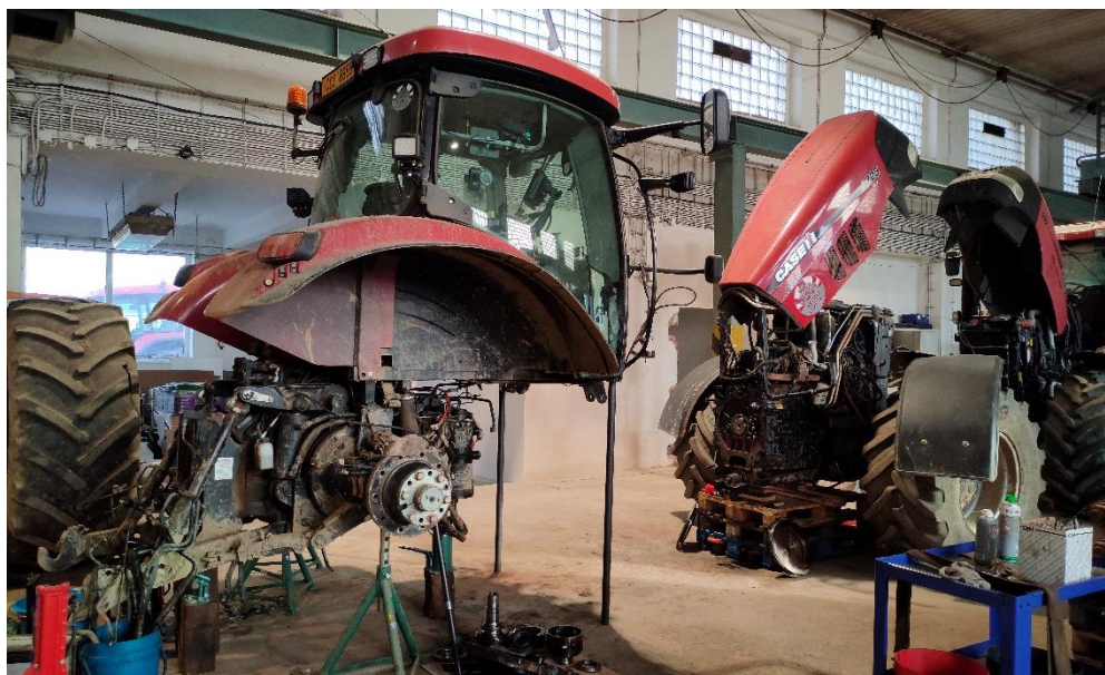
Obrázek 4.2: Rozdělení traktoru na dvě poloviny
