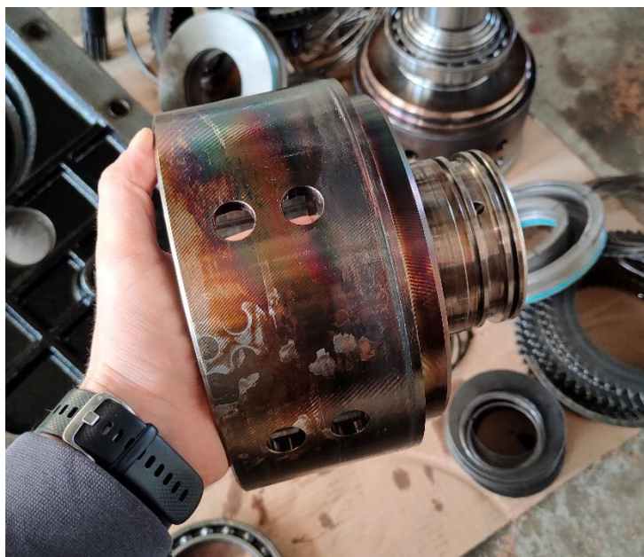
Obrázek 4.4: Zbarvení spojky vlivem extrémních teplot
