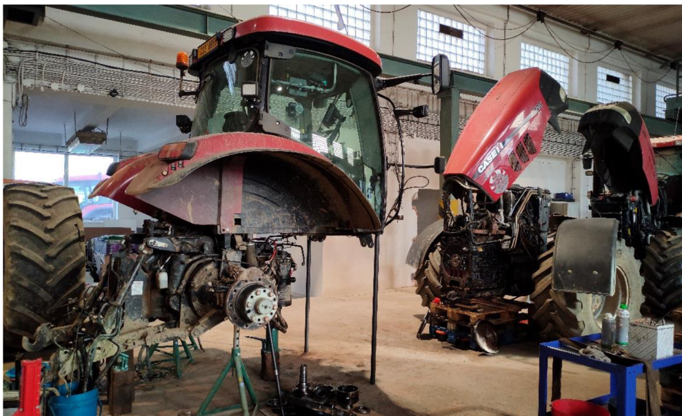
Obrázek 4.2: Rozdělení traktoru na dvě poloviny
