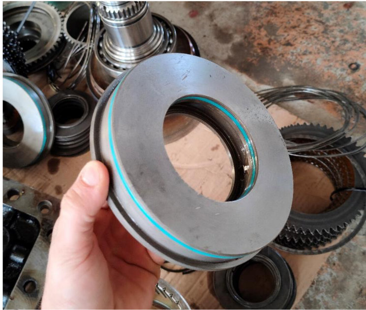
Obrázek 3.7: Píst pro spínání lamelových spojek
