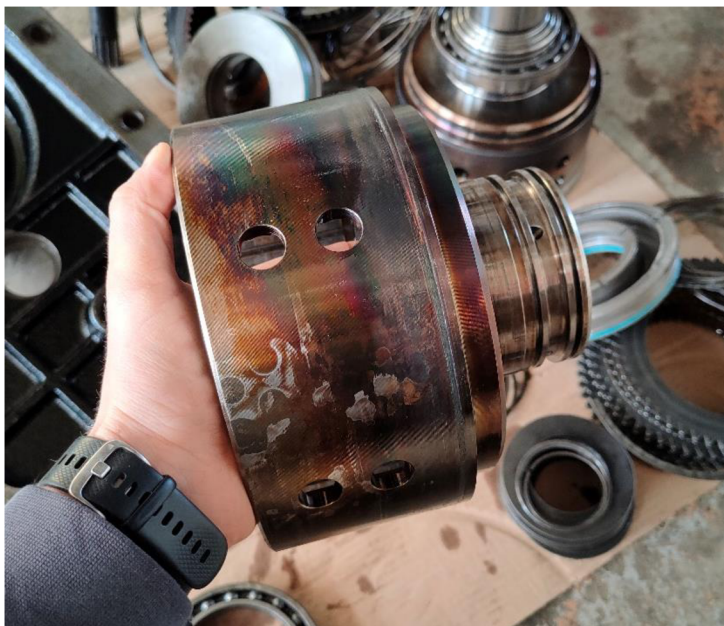
Obrázek 4.4: Zbarvení spojky vlivem extrémních teplot
