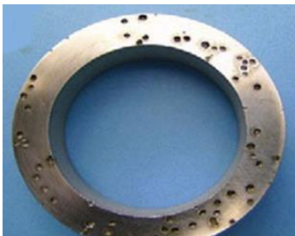
Obrázek 4 Důlková koroze v nerezové oceli [31]
