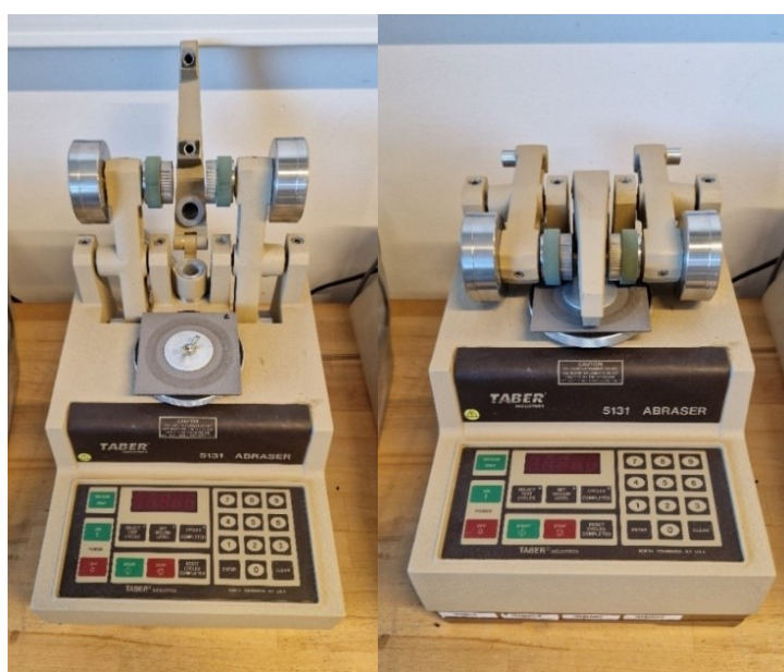
Obr. 3.13 Přístroj pro testování abrazivního opotřebení Taber Abraser 5131
