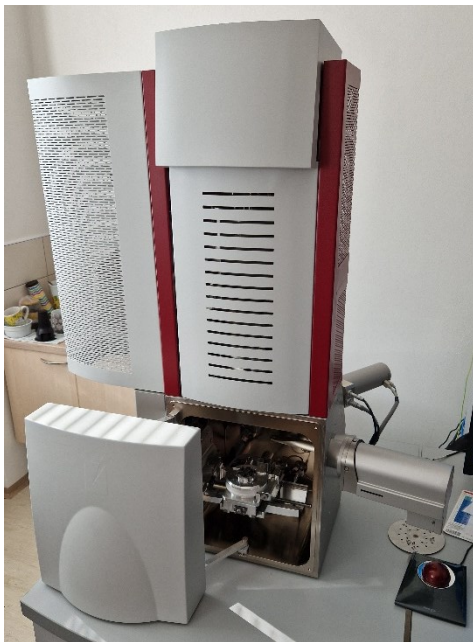
Obr. 3.18 Elektronový skenovací mikroskop Mira 3 (Tescan, Česká republika)
