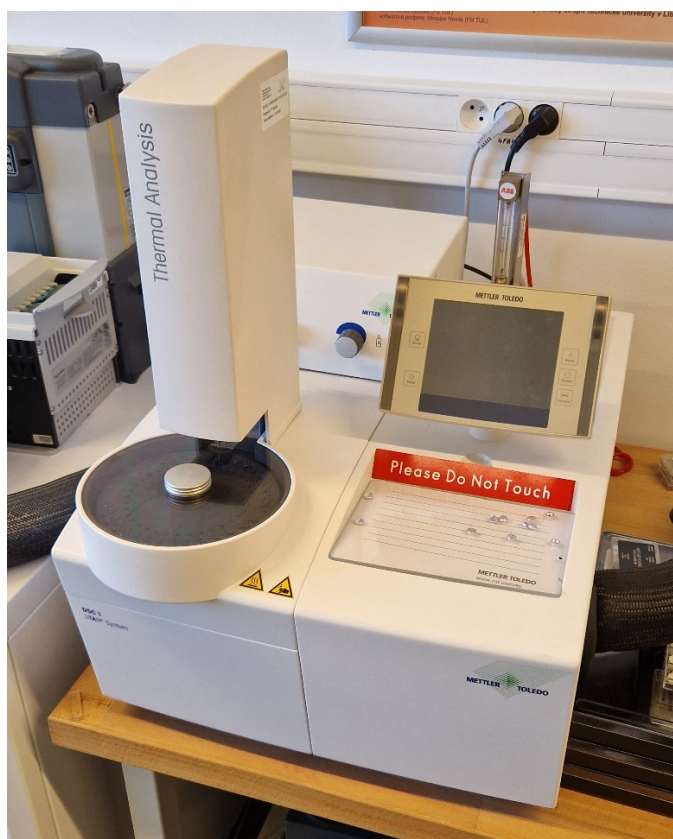
Obr. 3.11 Diferenční skenovací kalorimetr DSC1/700
