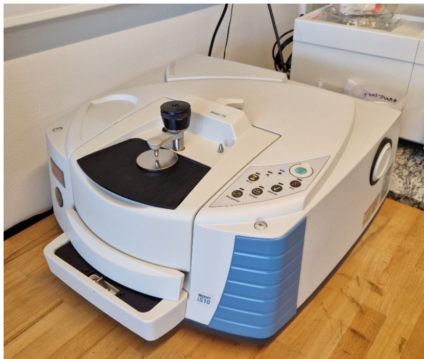
Obr. 3.1 FTIR spektrometr Nicolet iS10
