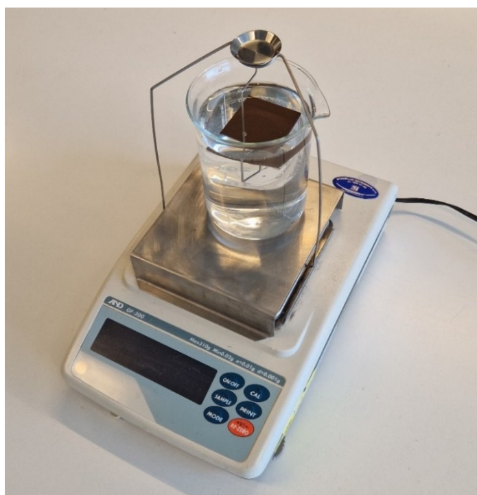
Obr. 3.14 Sestava pro měření hustoty imerzní metodou
