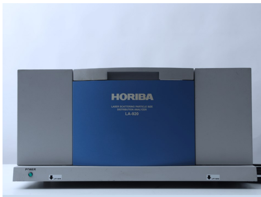
Obr. 3.6 Laserový difrakční analyzátor Horiba LA-920
