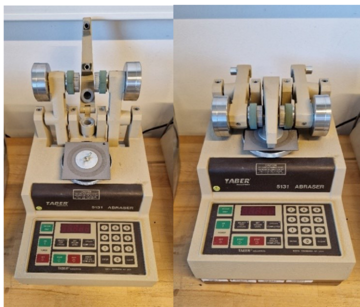
Obr. 3.13 Přístroj pro testování abrazivního opotřebení Taber Abraser 5131
