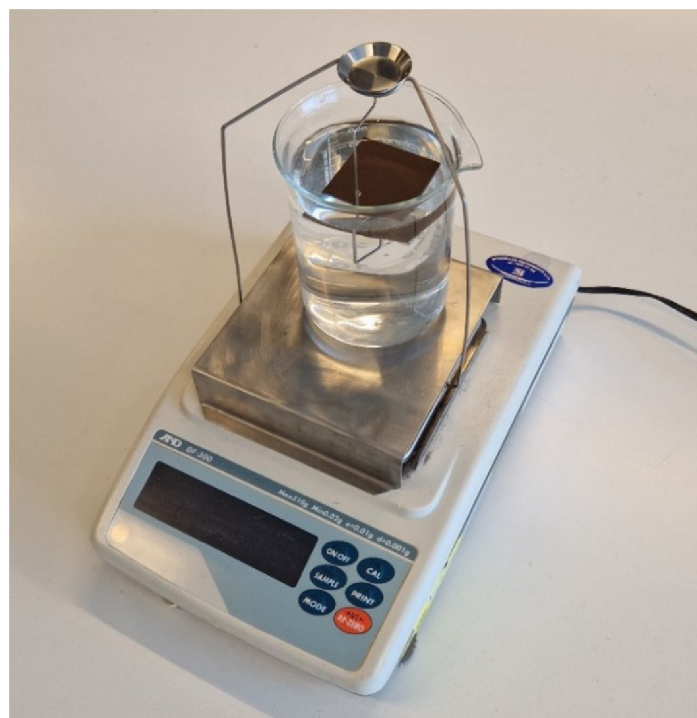
Obr. 3.14 Sestava pro měření hustoty imerzní metodou
