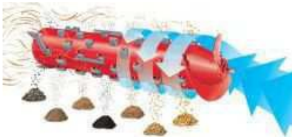
Obrázek 2.5 Axiální mláticí a separační systém CASE.
