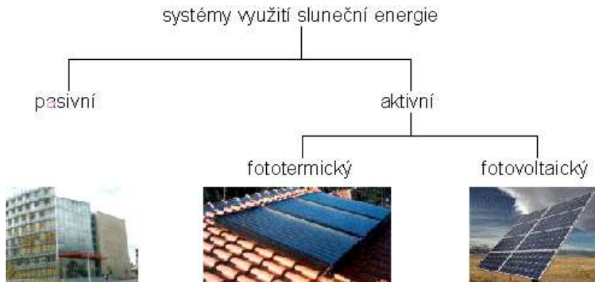
Obr. 3: Obecné rozdělení systému využití slunečního záření a jejich příklady. (60)
