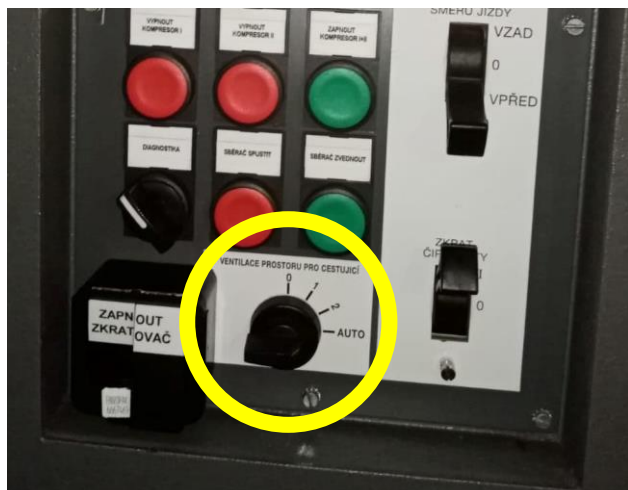
Obrázek 12 - Ovládání vzduchotechniky pro prostor cestujících
