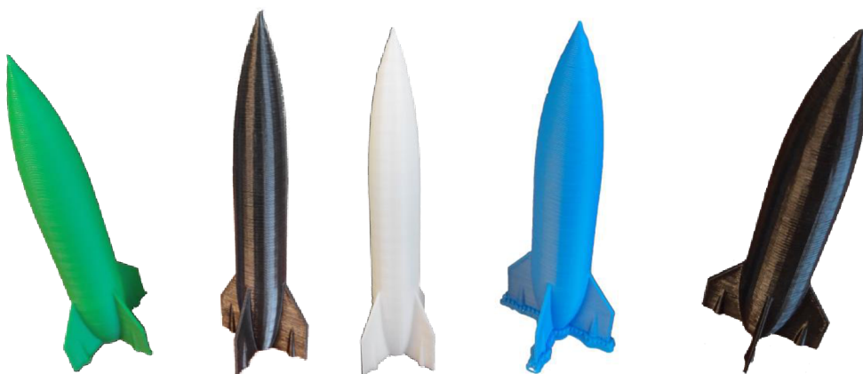
Validační výtisky raket (PLA-D, ABS M30i, PC, PLA, ABS)
