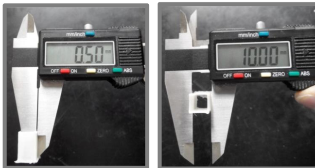
Obr. 4-21 Přeměření objektu digitálním posuvným měřidlem
