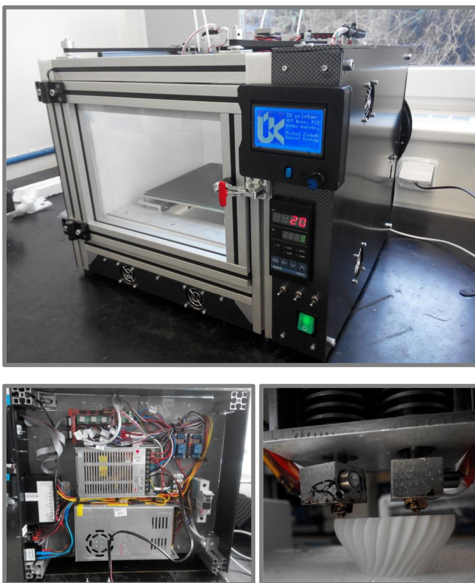
Obr. 4-15 Výsledná podoba tiskárny, elektroinstalace a první tisk
