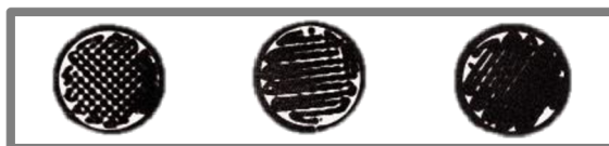
Obr. 1-6 Nehomogenity FDM objektu u obdélníkové výplně [10]
