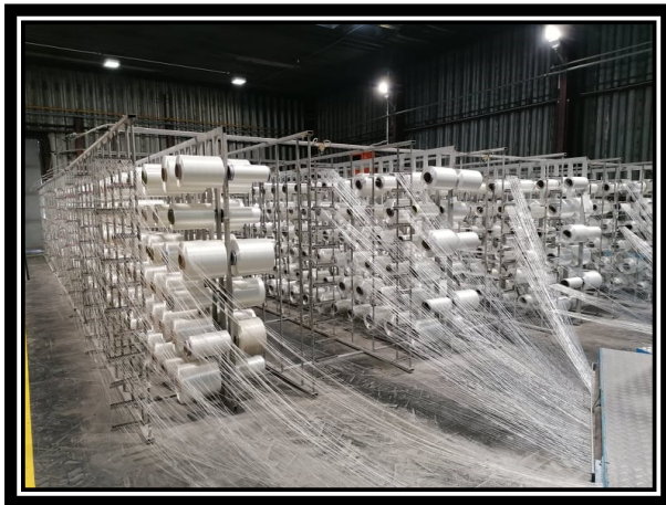
Obr. 3.6 Statívy s kotúčmi s multivláknovým nylonom zdroj: [15]
