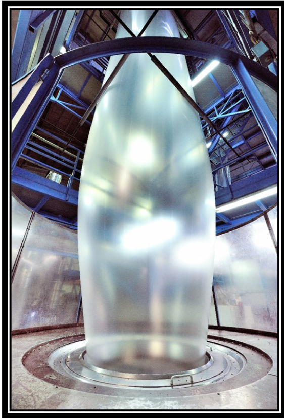
Obr. 3.3 Blower - Fúkací stroj zdroj: [15]
