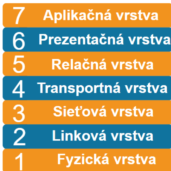
Obrázok č. 2 ISO OSI model (Zdroj: Vlastné spracovanie podľa 4, s. 13)
