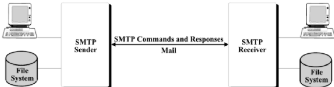
Obrázok č. 7 Príklad jednoduchej SMTP výmeny (Zdroj: 11, s. 655)
