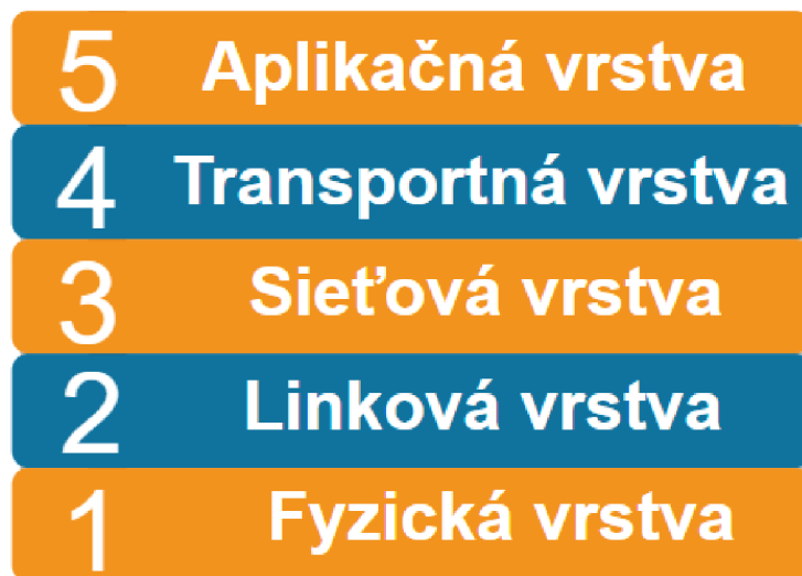
Obrázok č. 3 Päťvrstvový model internetových protokolov (Zdroj: Vlastné spracovanie podľa 3, s. 60)
