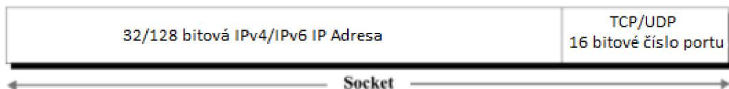
Obrázok č. 1 TCP/UDP socket (Zdroj: Vlastné spracovanie podľa 10, s. 477)
