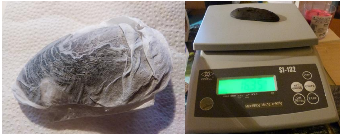
Obr. č. 3.3: (vlevo) Vysoušení lastur pomocí savého papíru před vážením mokré hmotnosti. (vpravo ) Digitální váha Excell SI-132 využívaná v terénu pro vážení lastur s přesností na dvě desetiny gramu. (Foto: Rambousková)
