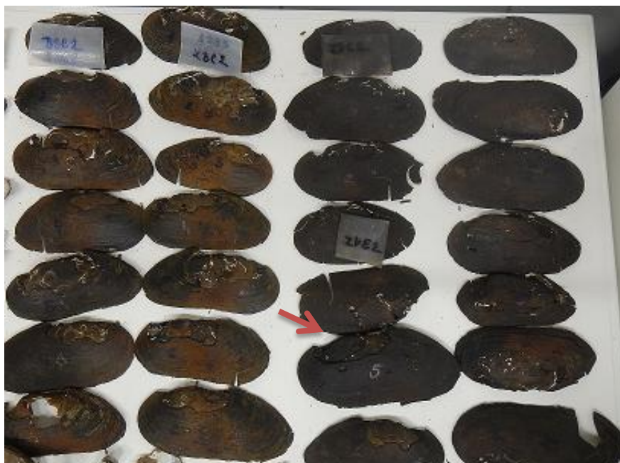
Obr. č. 8.1.: Degradace lastur po cca měsíci uložení v laboratorních podmínkách. (vlevo) lastury z Blanice s viditelnou železitou inkrustací na povrchu periostraka (vpravo) lastury z vody Zbytinského potoka bez inkrustace. Viditelné jsou frakturace lastur při jejich okrajích (viz šipka) (Foto: Simon 2015)
