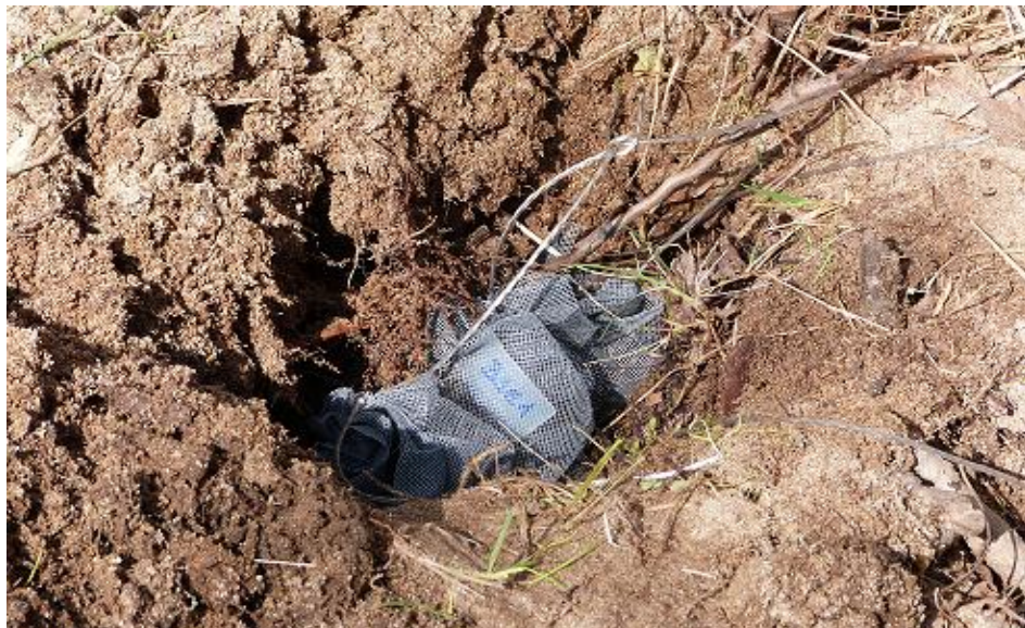
Obr. č. 3.2.: Instalace lastur do břehových sedimentů. (Foto: Rambousková 2014)
