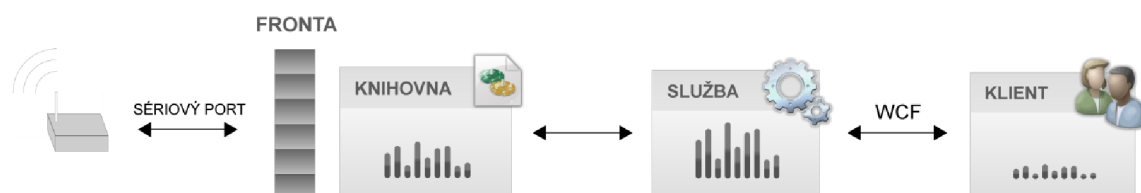
Obr. 3: Princip funkčnosti při použití třídy serveru jako služby
