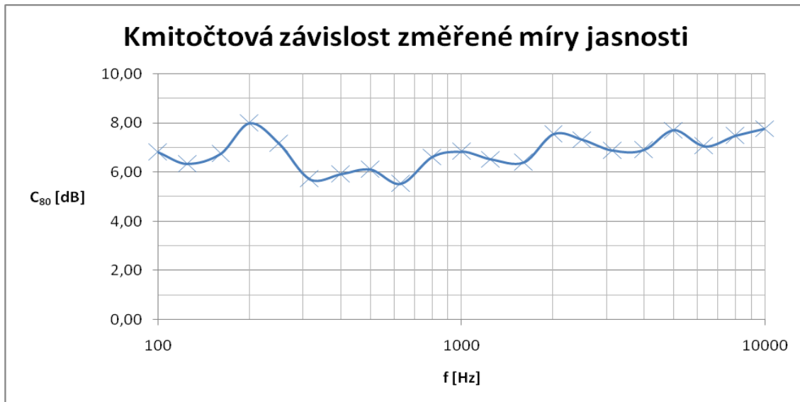
obr. 4.3: Změřená kmitočtová závislost C_{80}
