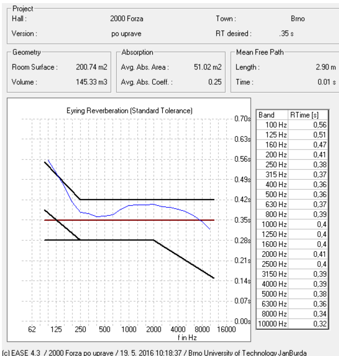
obr. 2.7: Simulovaná doba dozvuku po akustické úpravě
