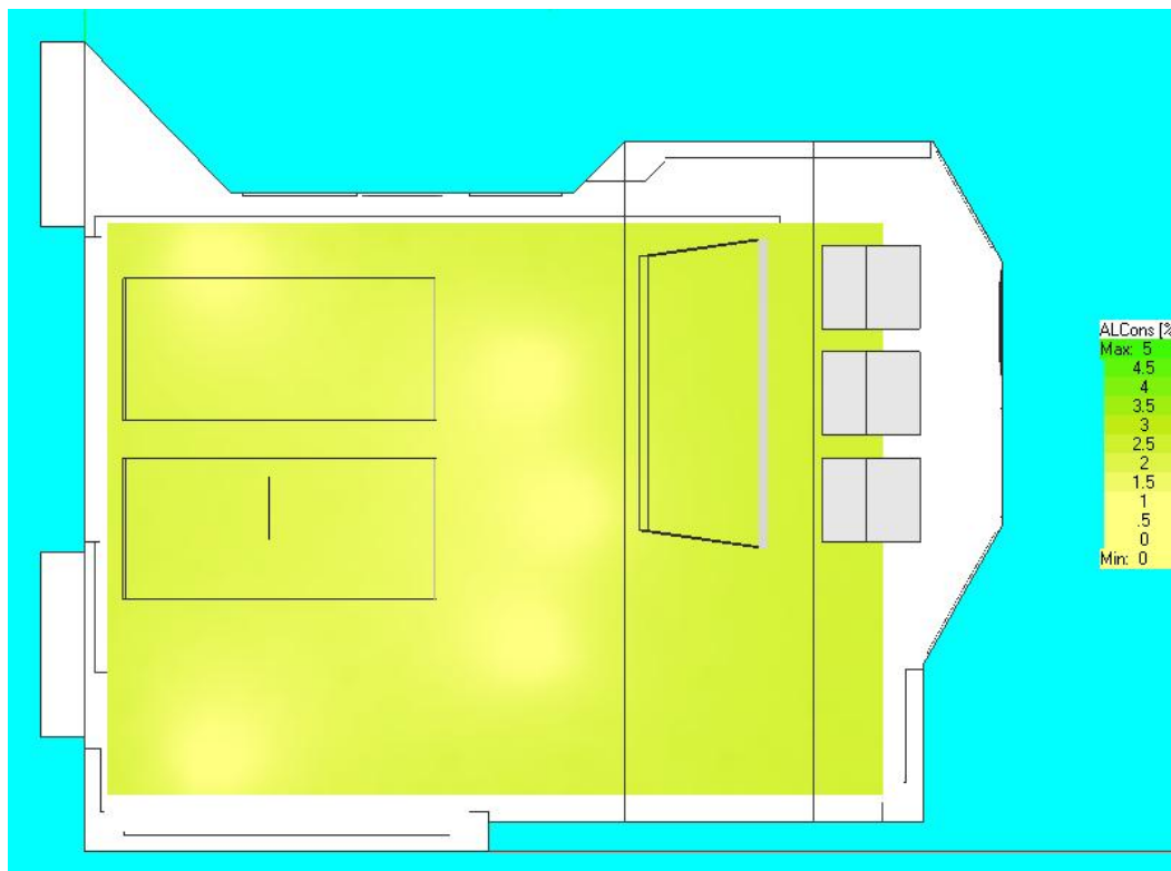
obr. 2.9: Simulace AL_{cons} po akustických úpravách
