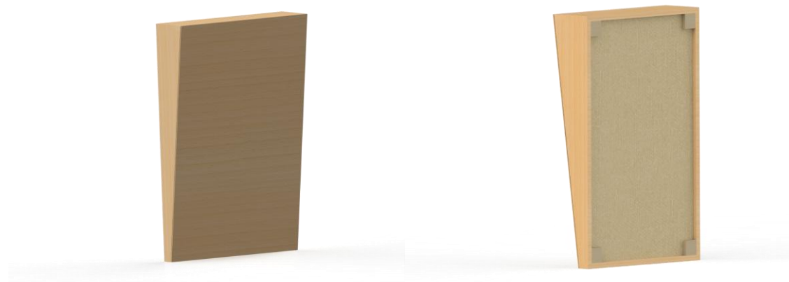
obr. 3.1: Model navrženého kmitajícího panelu v programu SolidWorks
