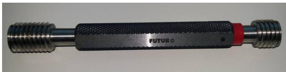
Obr. 1.21 Oboustranný závitový kalibr.
