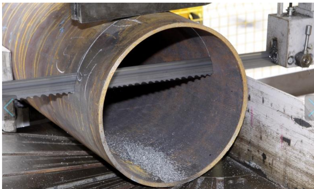
Obr. 1.8 Dělení pásovou pilou [6].
