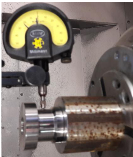
Obr. 2.8 Ustavení polotovaru při obrábění dle programu O03252.
