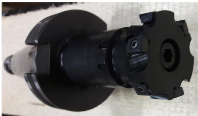
Obr. 2.1 Nový nástroj pro obrábění detailu T-drážky.
