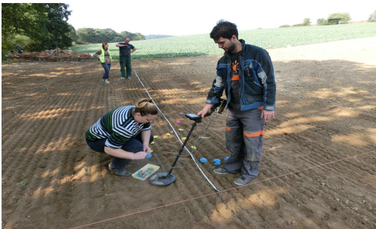
Vyhledávání hliníkových značkovačů s využitím detektoru kovů, vyznačování polohy značkovačů.
