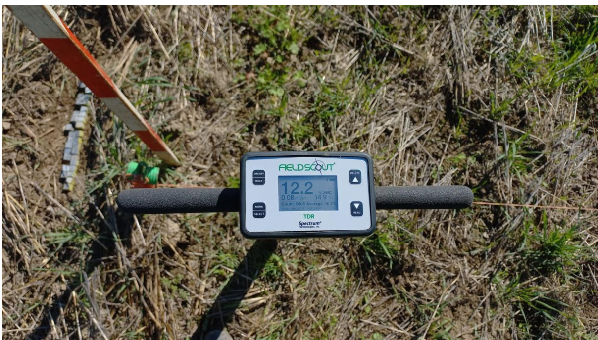
Měření půdní vlhkosti pomocí přístroje Fieldscout.
