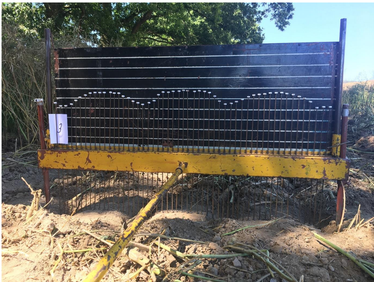
Profilograf byl použitý pro měření půdního povrchu.
