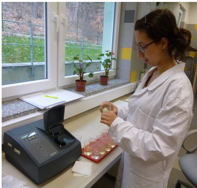
Obr. 5: Měření koncentrace amoniakálního dusíku na spektrofotometru Spectonis 20 Genesys (Foto J. Máchová).
