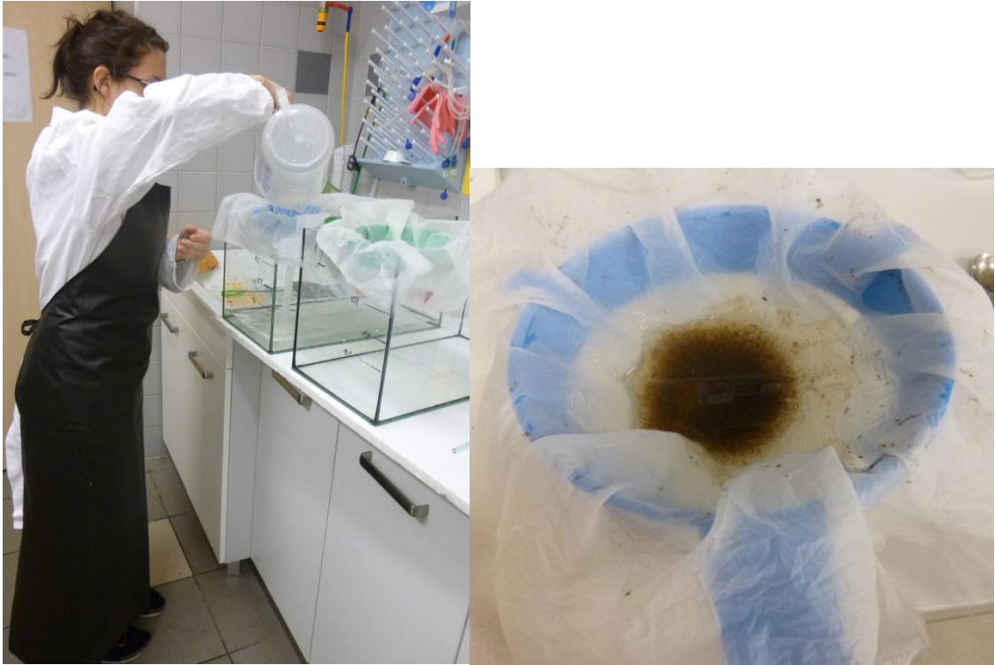
Obr. 3: Separace vodné a pevné fáze exkrementů filtrací přes uhelon 40 \mu\text{m} . (Foto J. Máchová).
