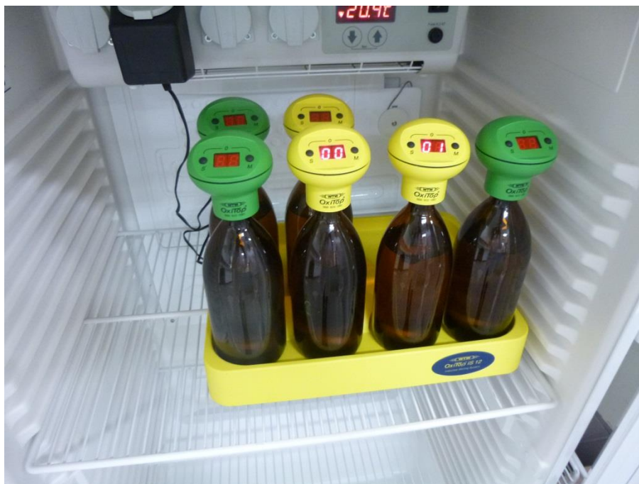
Obr. 7: Stanovení BSK 5 – reakční lahve s digitálními displeji na uzávěrech (Foto autor).
