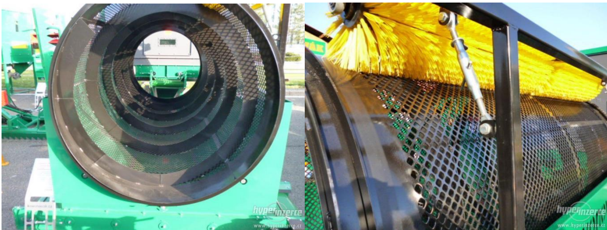
Obr.9 Bubnový tříděč se šroubovicí a nylonovým kartáčem [9]
