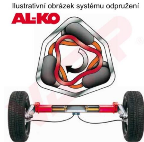
Obr.28 Pryžové odpružení naprav [23]
