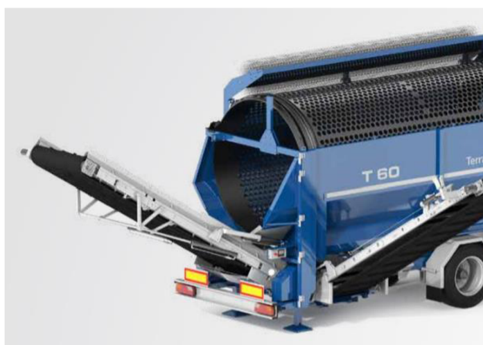
Obr.11 Řešení zachycení bubnu u mobilního třídíče [12]
