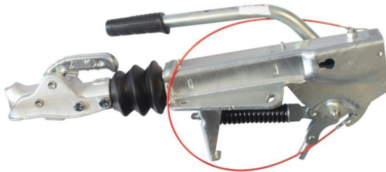
Obr.30 Tažné zařízení s nájezdovou brzdou [23]
