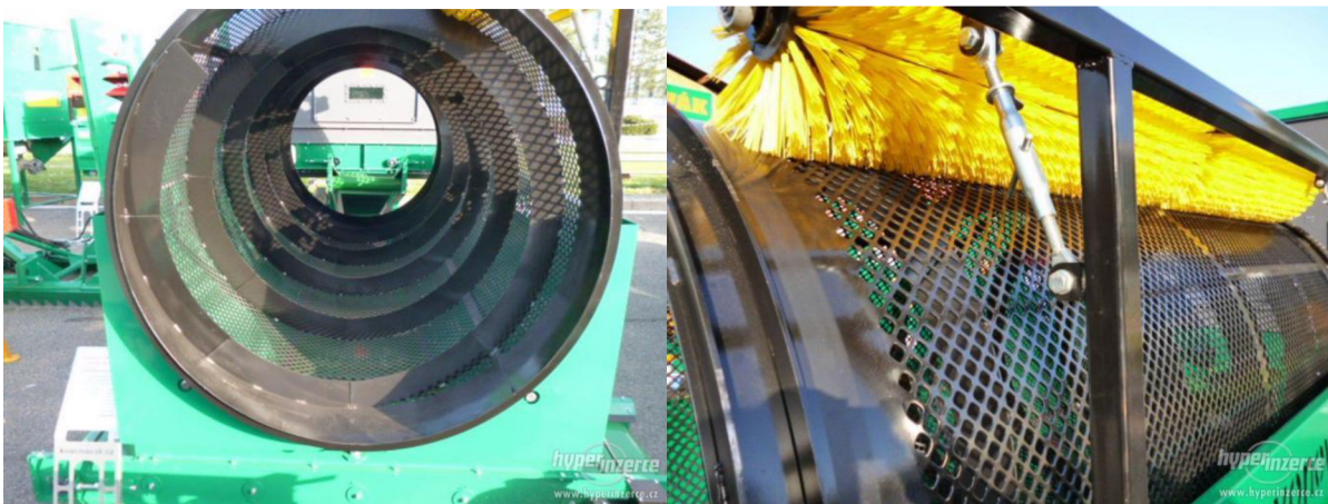
Obr.9 Bubnový tříděč se šroubovicí a nylonovým kartáčem [9]
