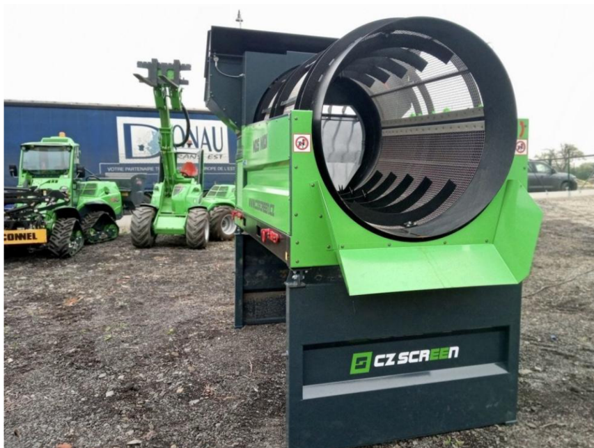
Obr.21 Bubnový třídíč firmy CZ Screen model MDS MDI [21]
