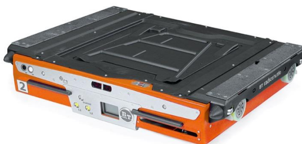
Obr. 19 Automatizovaný nosič nákladu
