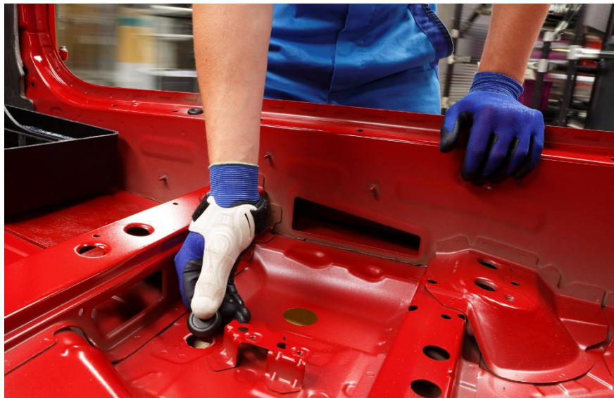
Obr. 29 Příklad 3D tištěného ergonomického nástroje výrobce BMW
