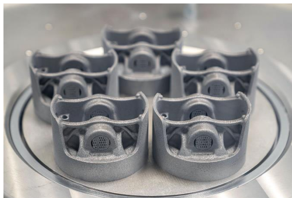
Obr. 23 Příklad 3D tištěných pístů motoru Porsche 911 GT2 RS
