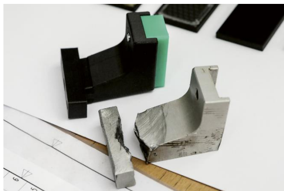
Obr. 36 Nově přepracovaný a vytištěný díl vs. poškozený původní díl
