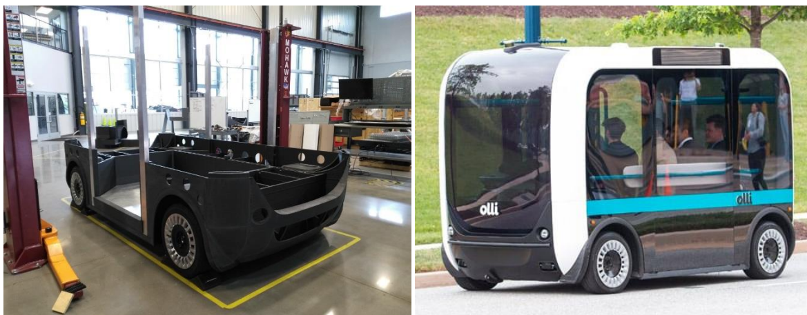
Obr. 42 Minibus Olli vytištěný na 3D tiskárně
