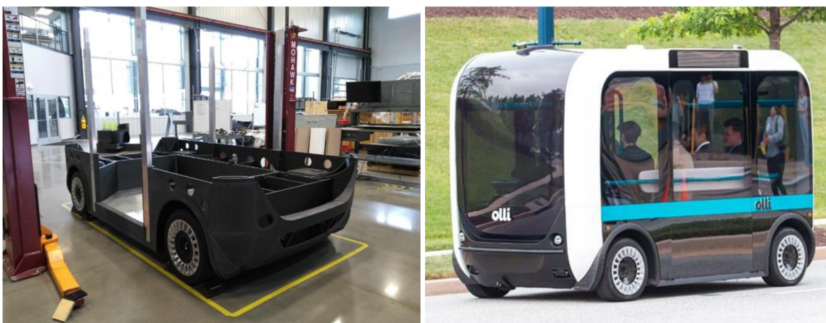
Obr. 42 Minibus Olli vytištěný na 3D tiskárně
