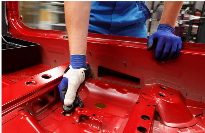
Obr. 29 Příklad 3D tištěného ergonomického nástroje výrobce BMW
