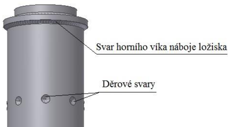
Obr. 31 Svary náboje ložiska ke sloupu
