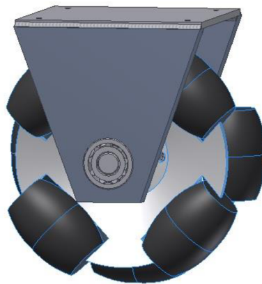
Obr. 35 Umístění ložiska všesměrového kola
