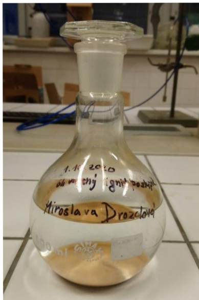
Obrázek 15: Lignit vařený 6 hodin v H_2O_2 s postupným přidáváním peroxidu
