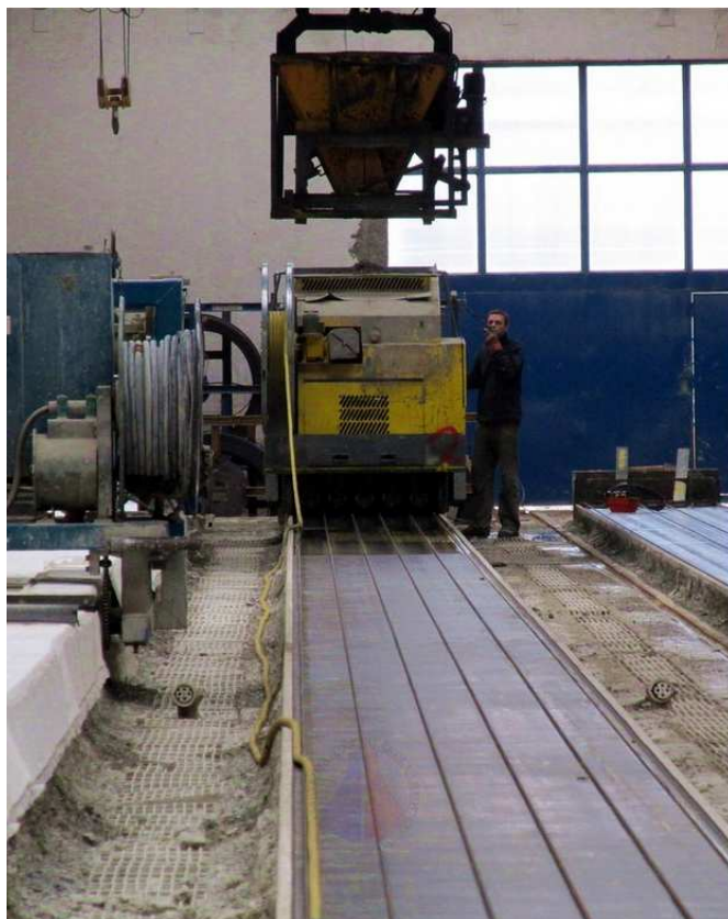
Obr. 7 Výrobní linka pro dutinové panely, prefa Kuřim [17]
