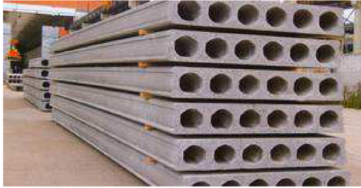
Obr. 9 Vyrobené panely ve skladu panelů
