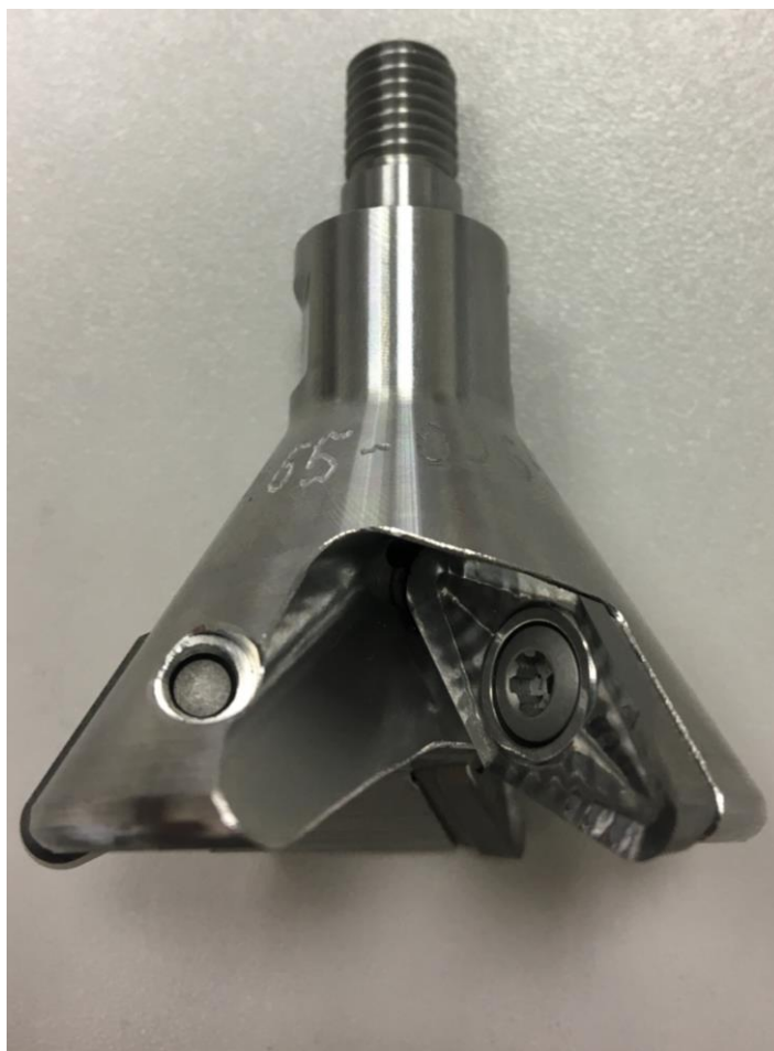
Obr. 4.14 Ponorná fréza s vyměnitelnými břitovými destičkami.
