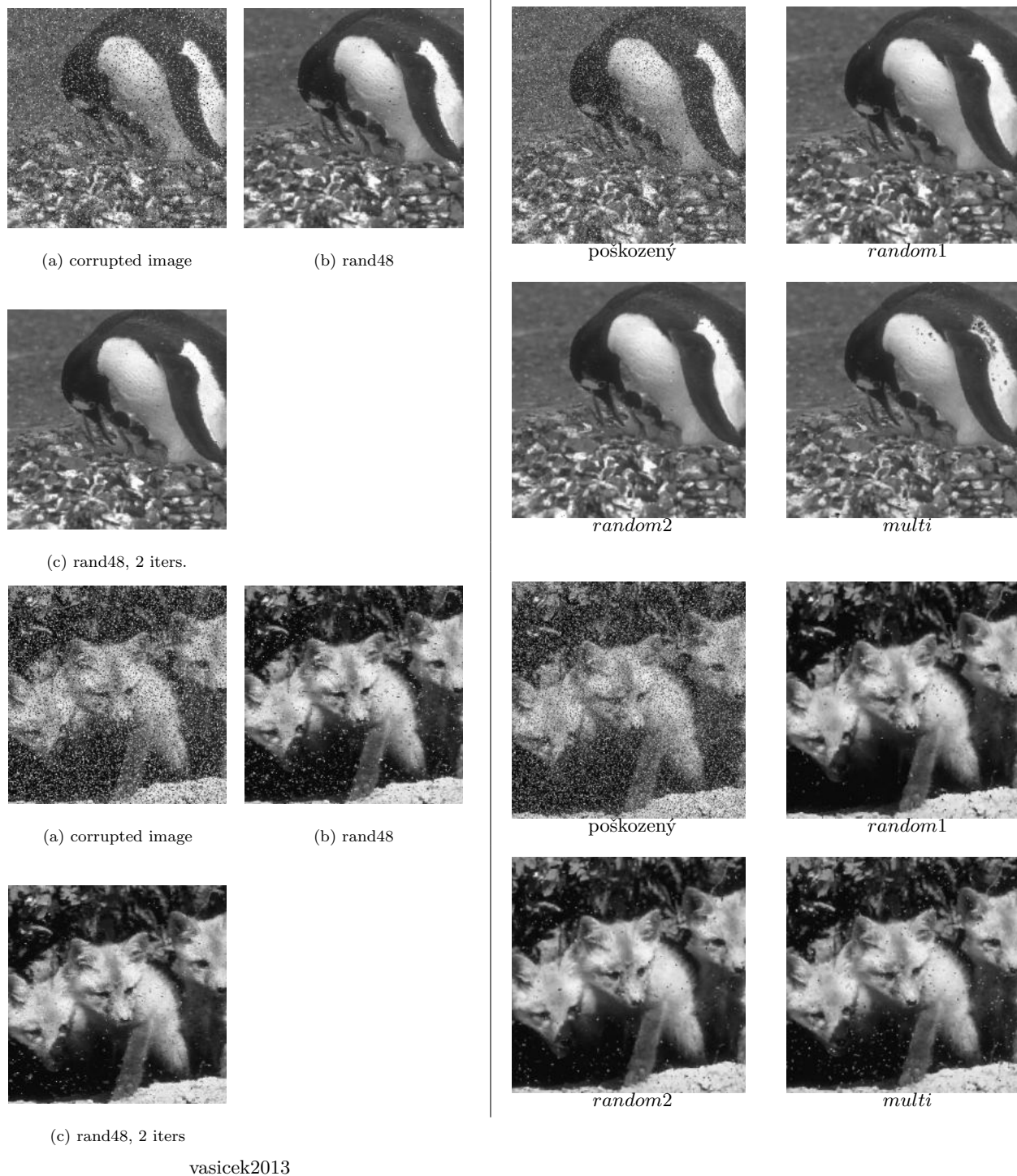
Obrázek 5.32: Porovnání kvality filtrace s metodou vasicek2013 na obrazech 106202 (tučňák) a 159008 (liščata) poškozenými náhodným šumem s intenzitami 20 % a 35 % respektive. Vlevo (označení vasicek2013 , převzato z [43]) je výsledek aplikace filtrů metody vasicek2013 , vpravo je výsledek aplikace navrhovaných filtrů. Filtry metody vasicek2013 byly vyhodnoceny po 1 nebo 2 krocích ( 2 iters ), navrhované filtry jsou vyhodnoceny po 6 krocích.
