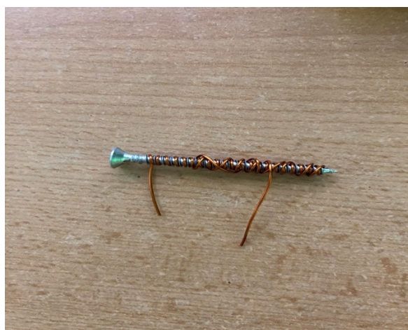
Obrázek 50 –experiment 6 - navnutí měděného drátu o délce 0,5 m na jádro
