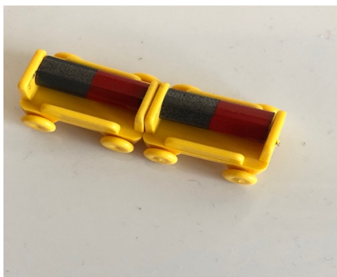
Obrázek 35 – experiment 1 – dva stejné póly magnetu
