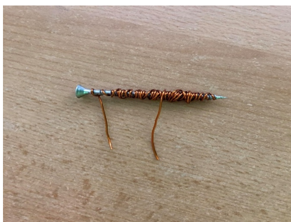
Obrázek 51 –experiment 6 - navnutí měděného drátu o délce 1 m na jádro
