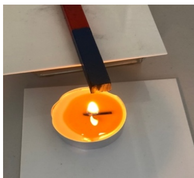
Obrázek 42 – experiment 3 - projev Curieovy teploty
