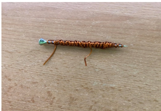
Obrázek 52 –experiment 6 - navinutí měděného drátu o délce 1,5 m na jádro
