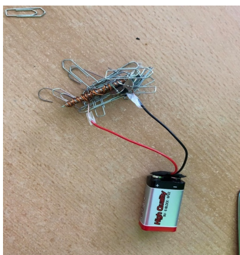
Obrázek 53 – experiment 6 - fungující elektromagnet o délce 0,5 m napájen 9 V
