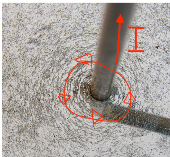
Obrázek 45 – experiment 4 – detail magnetických indukčních čar vodiče, kterým prochází elektrický proud [33]
