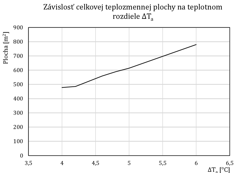
Graf 9.1 Závislosť celkovej teplozmennej plochy (primárnej aj sekundárnej) od teplotného rozdielu medzi vstupnou a výstupnou teplotou odpadného vzduchu.
