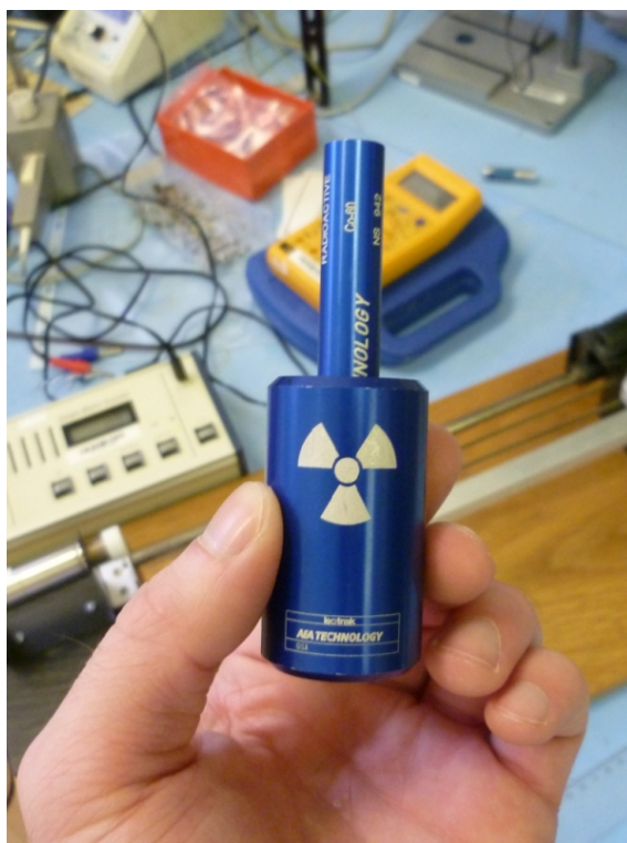
Obr. 1.3: Kobaltový zářič Co-60.
