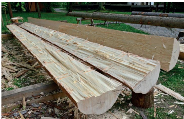
Obr. 3.4.2.2: Rozštípnutá kulatina (Kloiber a kol., 2020).
