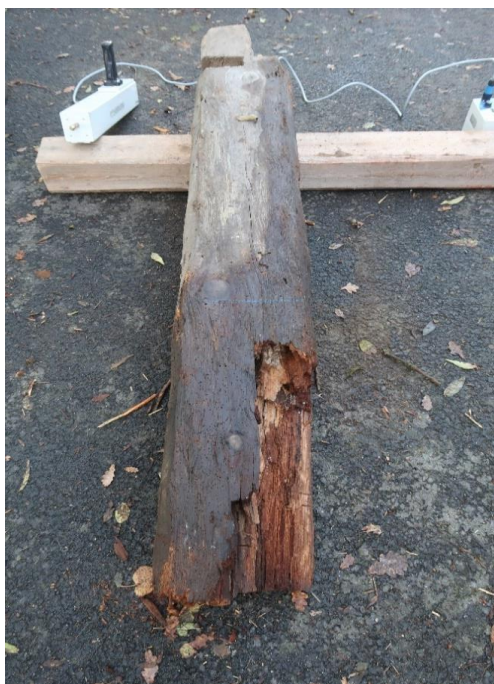
Obr. 3.9.3: Změna barvy působením vlhkosti.
