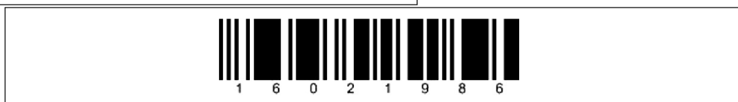
Obrázek 2.7: Čárový kód Code 2/5 interleaved
