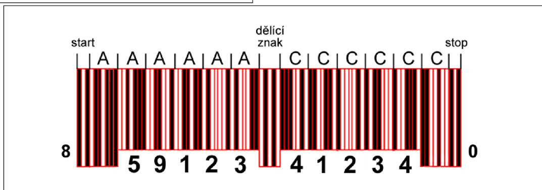
Obrázek 3.4: Formát symbolu UPC–A
