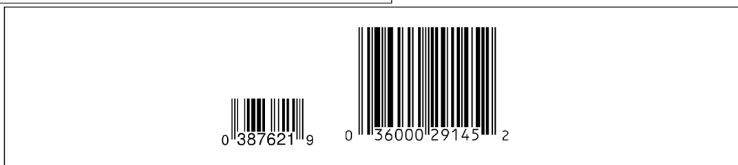
Obrázek 2.9: Čárový kód UPC–E a UPC–A
