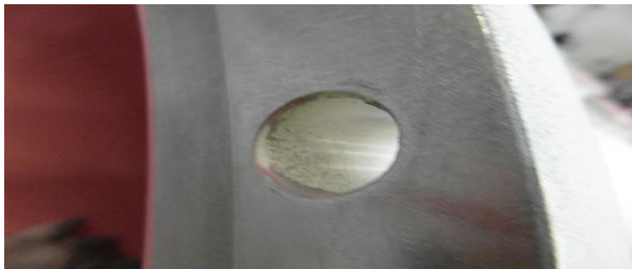
Obrázek číslo 53: Nálitek u menšího kruhového otvoru
