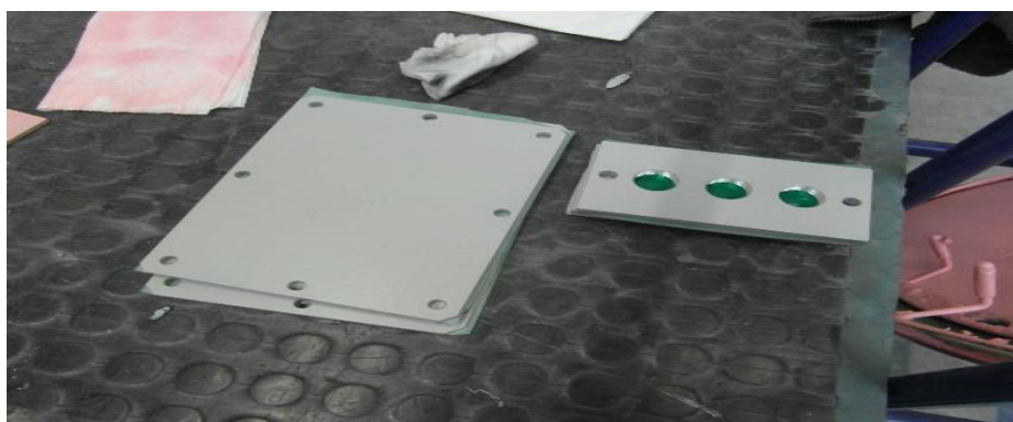
Obrázek číslo 58: Kryty k transformátoru
