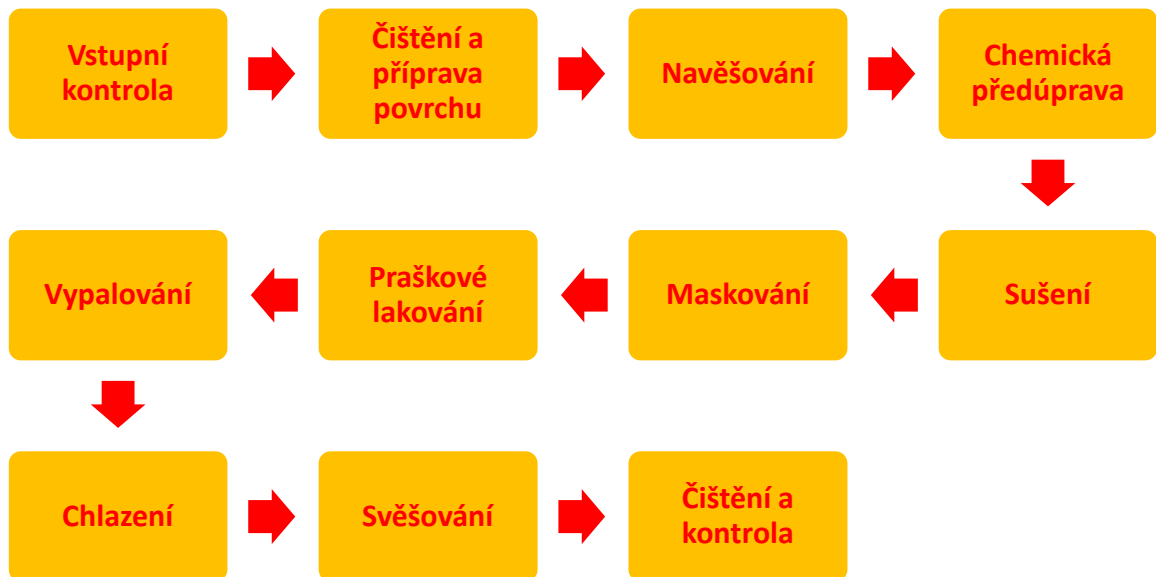
Obrázek číslo 9: Zobrazení lakovacího procesu v podniku
