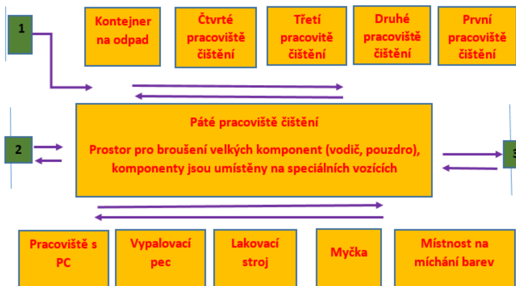
Obrázek číslo 30: Schématické uspořádání pracoviště čištění komponent
