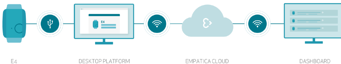
Obrázek 3.2: Schéma pro nahrávání dat do vnitřní paměti zařízení a následné získání dat.
